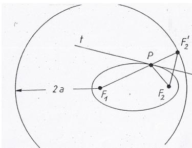
Abbildung 19: Leitkreiskonstruktion einer Ellipse
