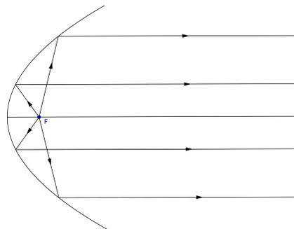
Abbildung 23: Strahlengang in einer Parabel
