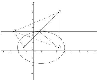
Abbildung 18: Mittelsenkrechtenkonstruktion der Tangente an die Ellipse
