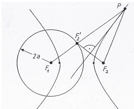
Abbildung 25: Leitkreiskonstruktion einer Hyperbel
